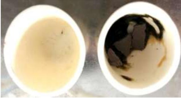
**Рис. 5.** Справа — проба антипирена; слева — проба натриевого жидкого стекла без добавок после завершения термического анализа
