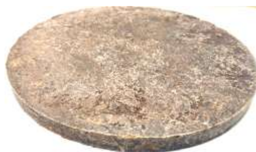
Рис. 2. Образец ДПК из древесной муки и полимеров
