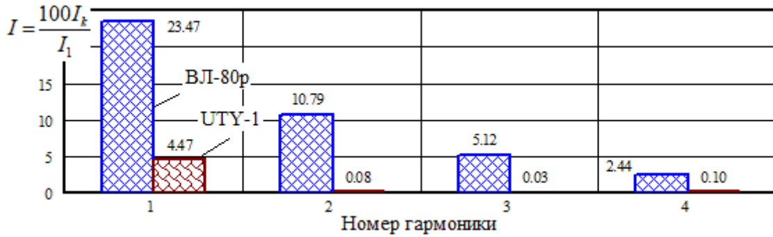
Рис. 1. Спектры гармоник токов электровозов ВЛ-80р и УТУ-1
