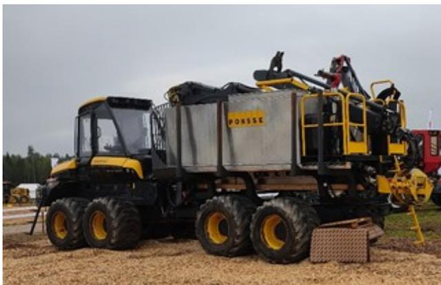
Рис. 3. Противопожарный форвардер Ponsse
