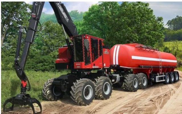
Рис. 2. Противопожарный форвардер Timber Pro
