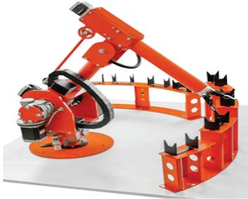
Рис. 7. Робот-манипулятор Delta
