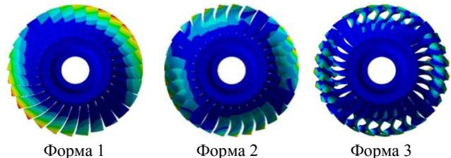
Рис. 6. Формы собственных колебаний рабочего колеса без расстройки
