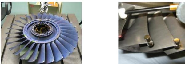
Рис. 5. Реальное рабочее колесо с дополнительными массами
