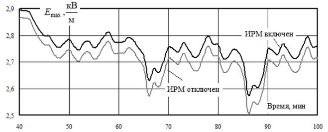
Рис. 16. Динамика изменения амплитуды напряженности электрического поля под линией ДПР:  $x = 6$  м;  $y = 1,8$  м
