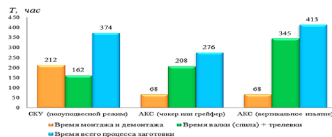
Рис. 2. График сравнения рабочего времени АКС и СКУ, потраченного на разработку лесного участка
