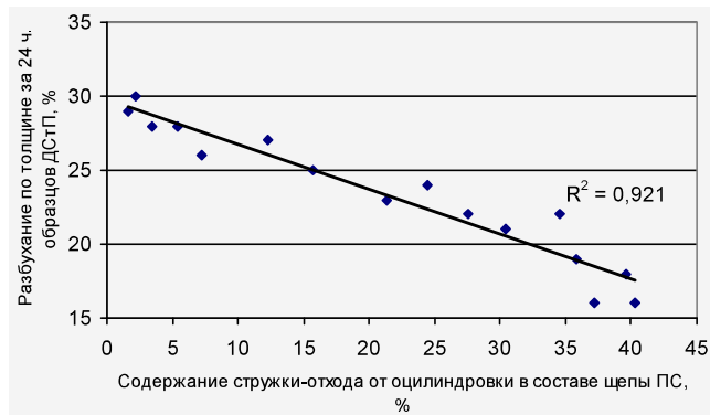
Рис. 7. Зависимость разбухания по толщине за 24 ч образцов ДСтП от содержания стружки — отхода оцилиндровки в составе щепы ПС
