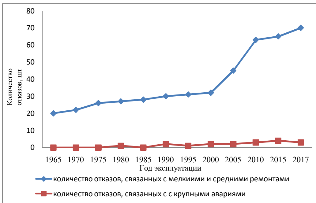
Рис. 4. Анализ аварийности преобразовательных трансформаторов алюминиевого завода
