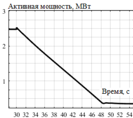
Рис. 10. Осциллограммы активной и реактивной мощностей на вводе 110 кВ
