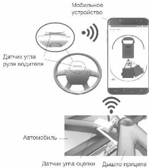
Рис. 3. Мобильная система помощи водителю автомобиля с прицепом при маневрировании задним ходом
