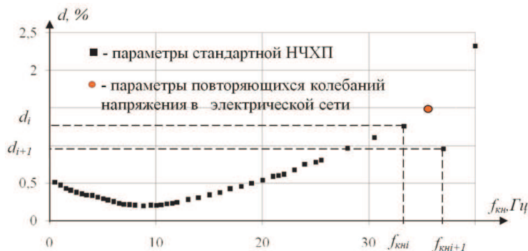
Рис. 2. НЧХП и параметры повторяющихся колебаний напряжения в электрической сети
