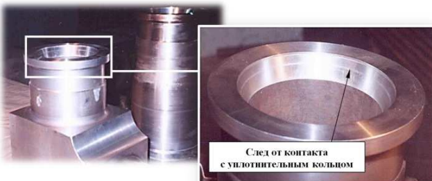
Рис. 5. След от контакта с уплотнительным кольцом на металле концевой части трубы БРС
