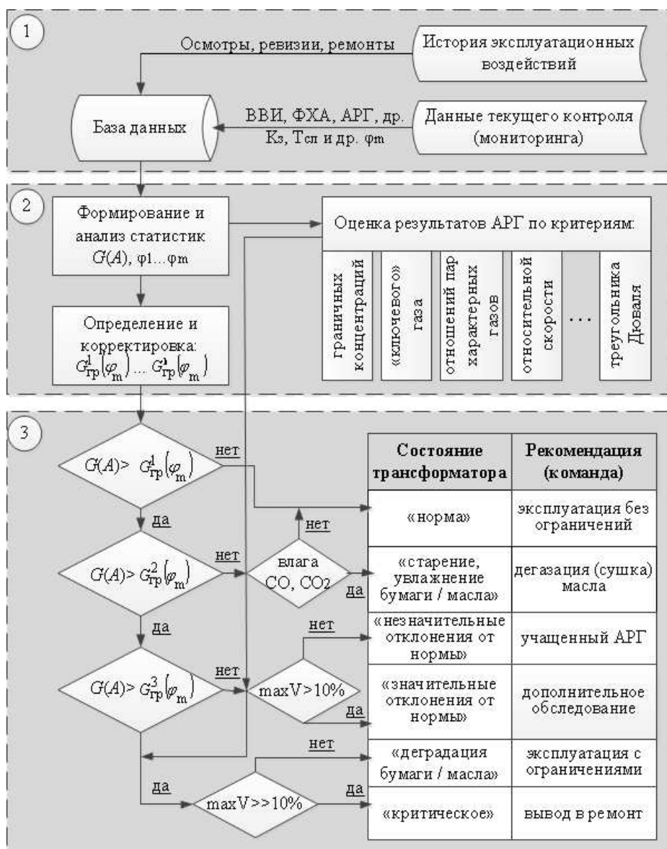
Рис. 1. Алгоритм принятия решений по эксплуатации трансформатора
