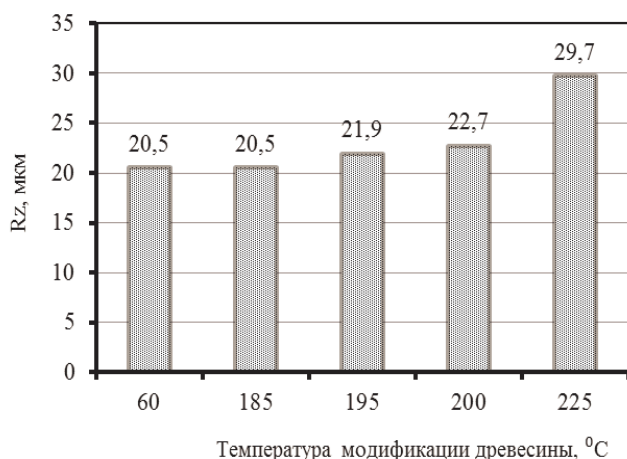
Рис. 1. Изменение шероховатости поверхности подложки в зависимости от температуры термообработки
