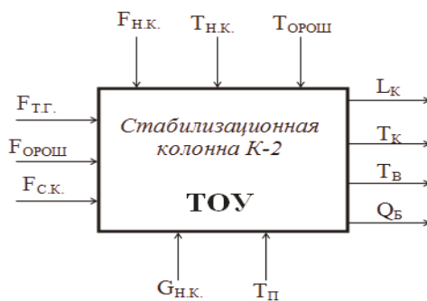
Рис. 2. Анализ стабилизационной колонны К-2 как объекта управления
