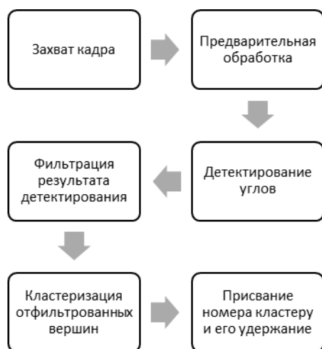
Рис. 2. Схема работы аналитического алгоритма распознавания
