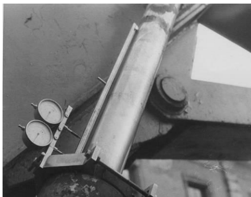
Рис. 17. Устройство для контроля угловой несоосности несущих длинномерных элементов гидроцилиндра.
