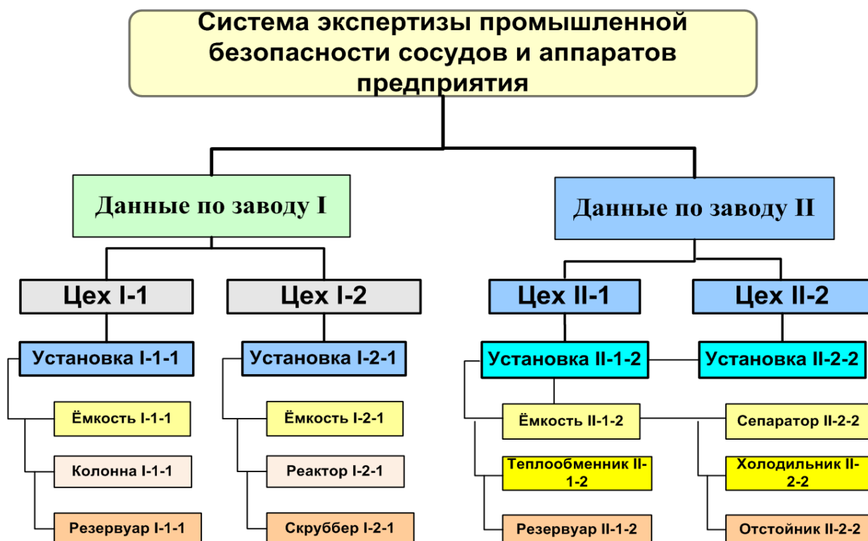
Рис. 22. Структурная схема автоматизированной системы промышленной безопасности СИА предприятия
