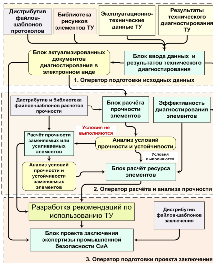
Рис. 15. Структурная схема КомКОРД при экспертизе СиА
