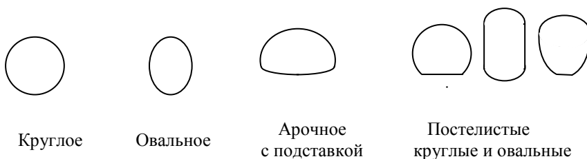
Рис. 5.2. Виды сечений безнапорных труб
