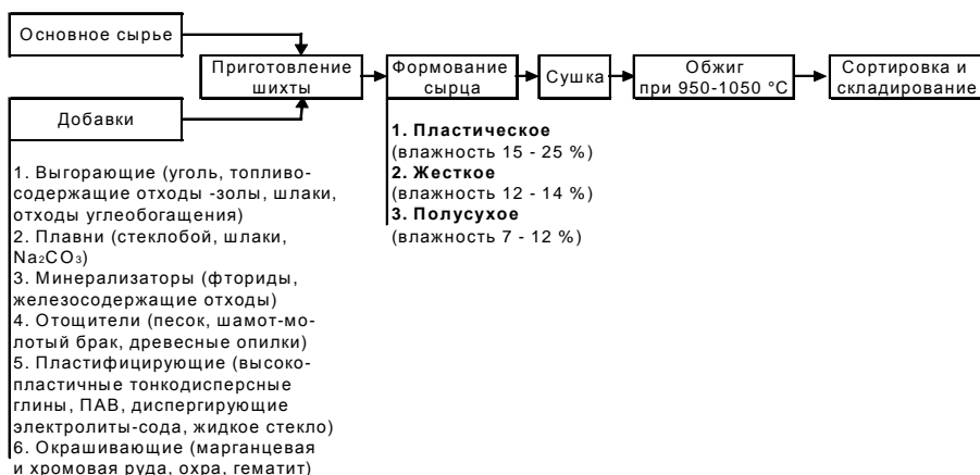
Рис. 2.1. Схема изготовления керамических изделий
