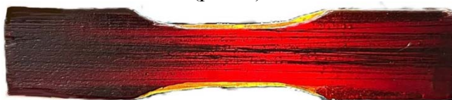
Рис. 5. Опытный образец, полученный в результате намотки волокон
