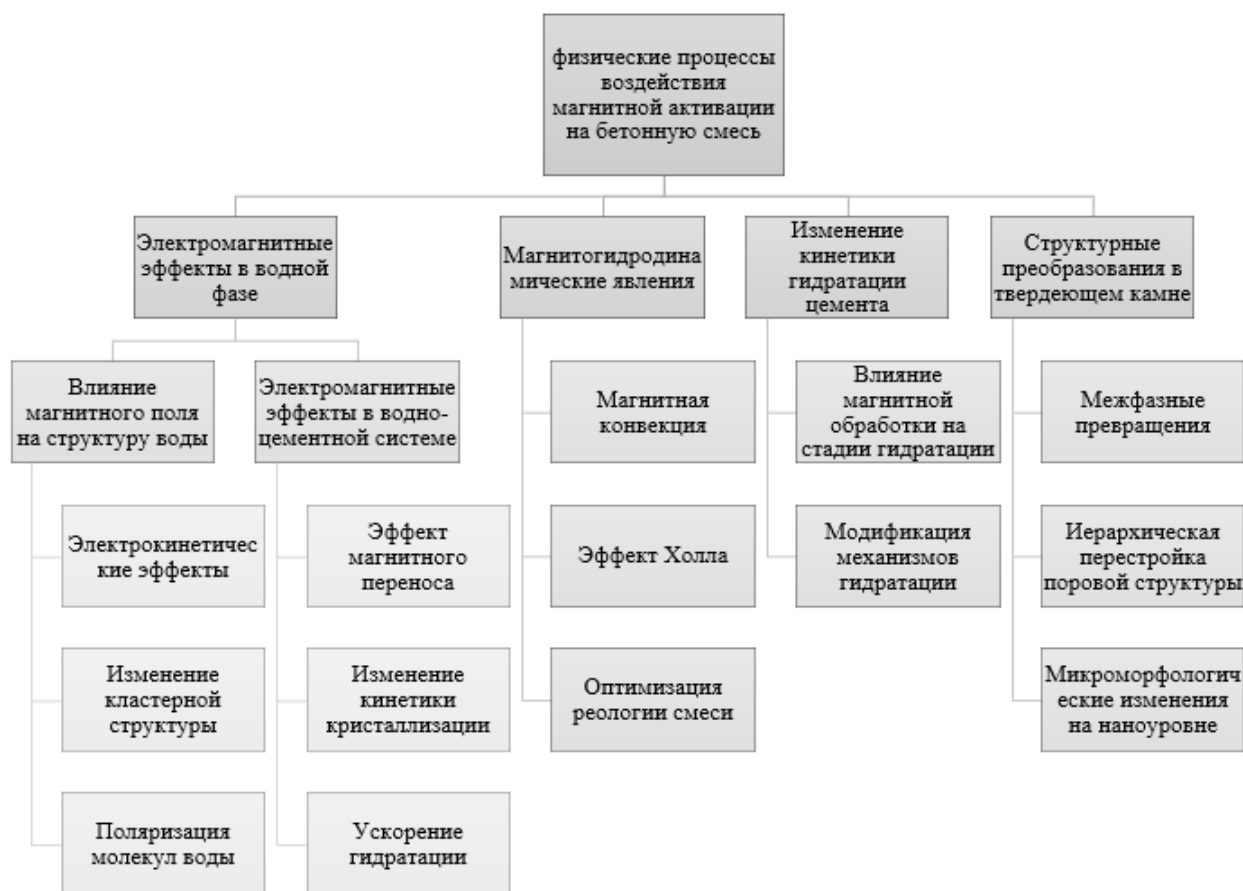
Рис. 1. Физические процессы, происходящие в бетонной смеси при её активации магнитным полем
