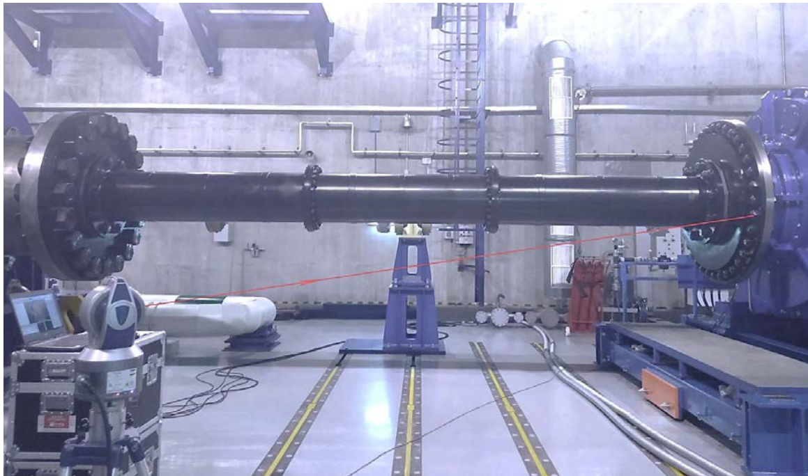
Рис. 4. Использование лазерного трекера в производстве (контроль размеров трансмиссии)
