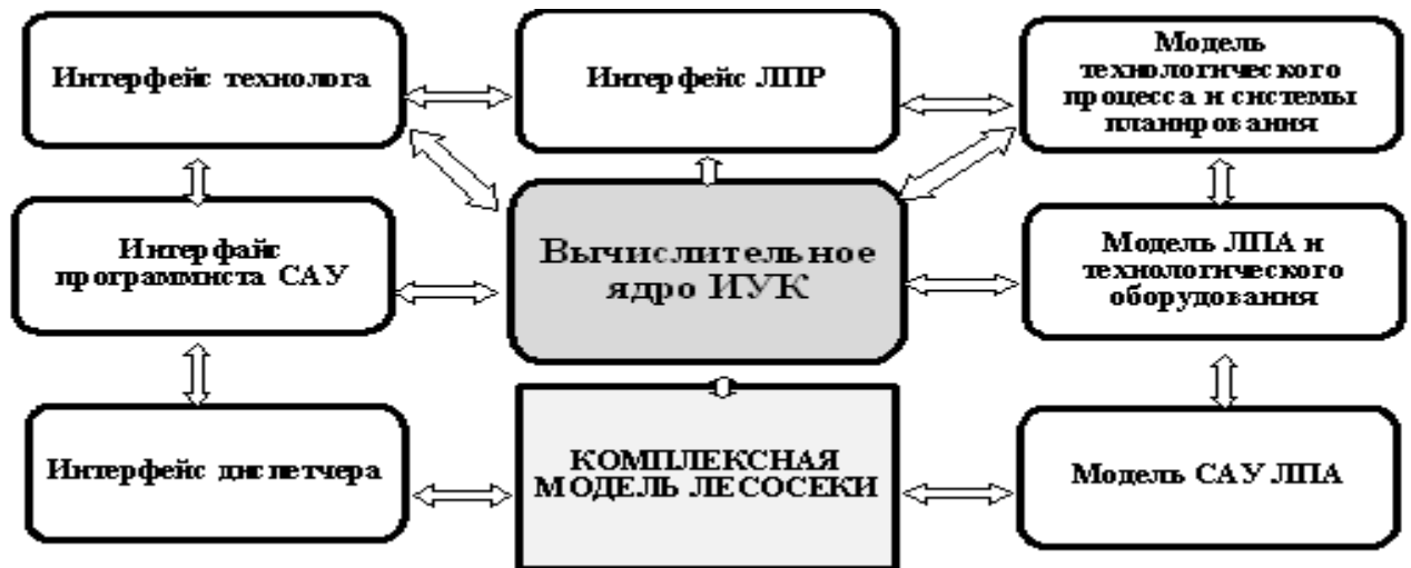
Рис. 2. Архитектура информационно-управляющего комплекса: ЛПР - лицо, принимающее решение, САУ - система автоматического управления, ЛПА — лесной агрегат, ИУК - информационно-управляющий комплекс
