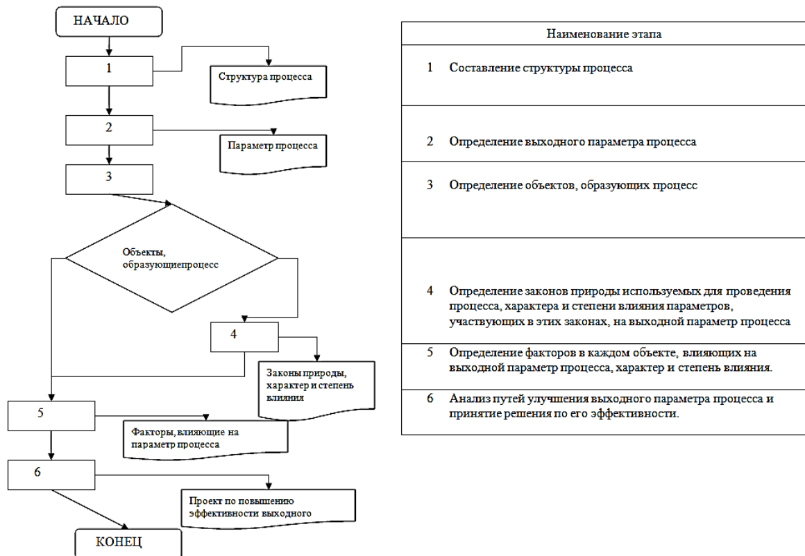
Рис. 1. Алгоритм принятия рационального решения по повышению эффективности выходных параметров процесса
