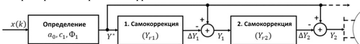
Рис.4. Принцип работы итерационного алгоритма самокоррекции коэффициентов a_0, c_1, \Phi_1 , выполняемого два раза подряд
