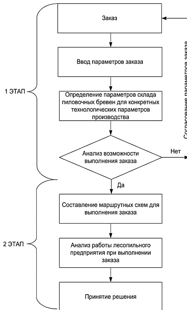
Рис. 2. Укрупнённый алгоритм определения целесообразности выполнения нового заказа
