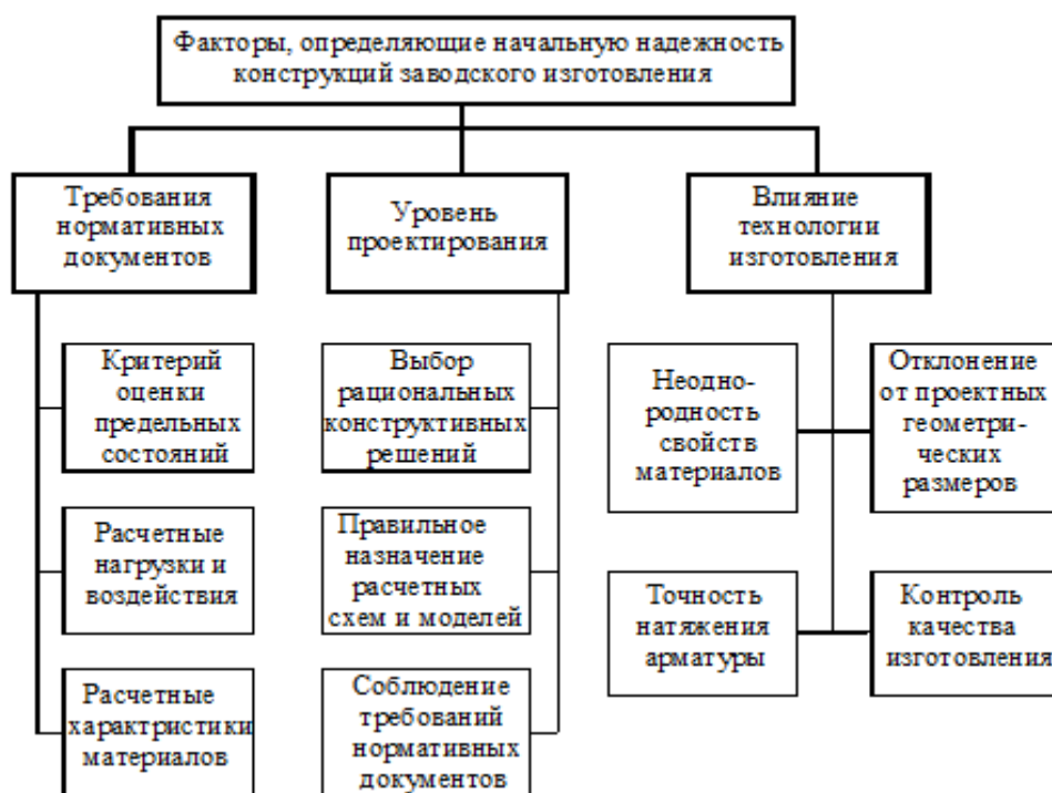
Рис. 1. Факторы, определяющие начальную надежность железобетонных конструкций заводского изготовления
