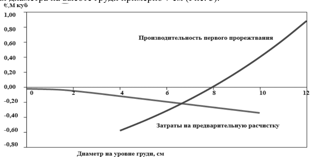
Рис. 3. Предварительная расчистка, проводимая с помощью мотокустореза при условии, если стоимость древесины на погрузочной площадке составляет 30 €/м³, стоимость механизированной заготовки – 85 €/час и стоимость предварительной расчистки – 30 €/час
