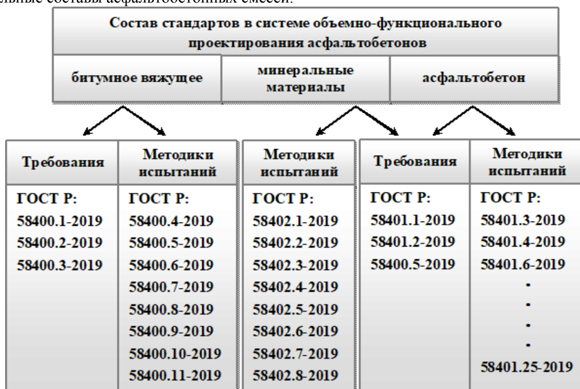
Рис.1. Состав стандартов в системе объемно-функционального проектирования асфальтобетонов
