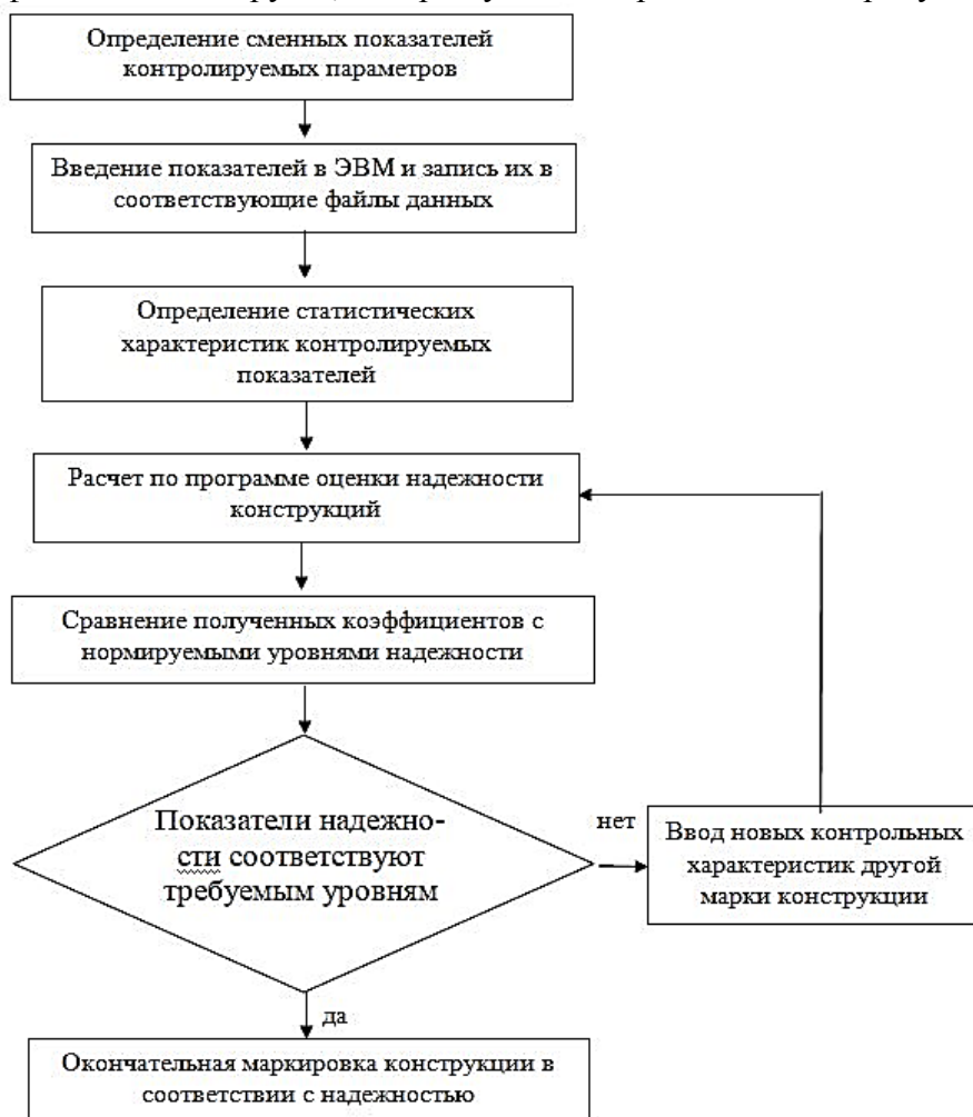
Рис. 1. Укрупненная блок-схема неразрушающего контроля качества сборных ЖБК
