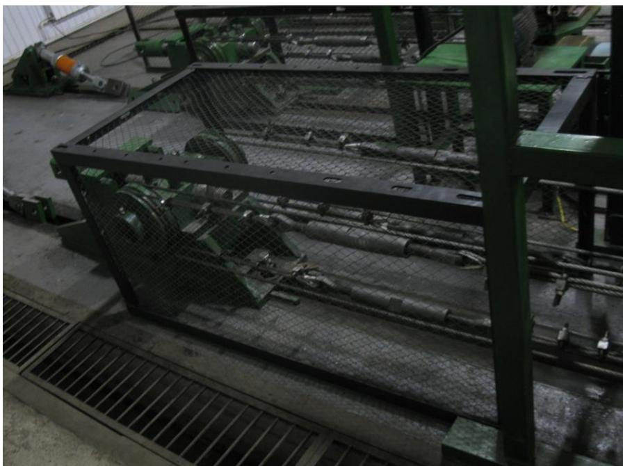
Рисунок 4.19. Натяжное устройство для вибрационных испытаний изделия
